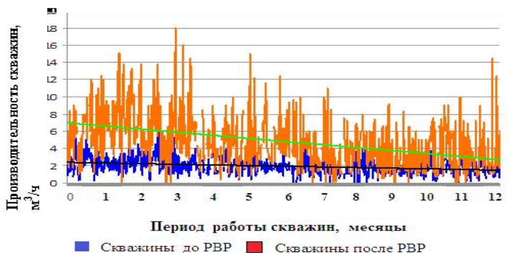
Рис. 4. Зависимость изменения производительности закачных скважин в течение первого года (2018) работы / Fig. 4. Dependence of injection well productivity change during 1 year (2018) of their operation
