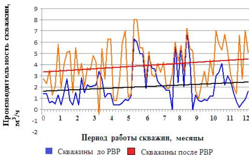
Рис. 10. Зависимость изменения производительности откачных скважин в течение второго года (2019) работы / Fig. 10. Dependence of pumping well productivity change during 2 years (2019) of their operation
